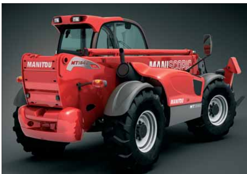
■ I sollevatori MT Privilege si caratterizzano per un interessante rapporto compattezza/prestazioni di sollevamento, in virtù delle loro dimensioni (larghezza di 2,38 m; altezza di 2,5 m)
