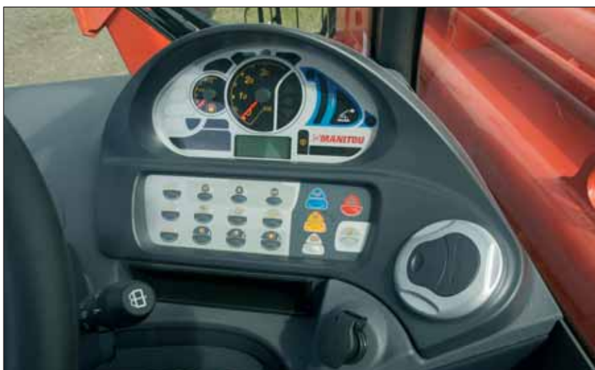
■ La cabina ROPS/FOPS è realizzata con concezione automobilistica, evidenzia un volume interno di 2 m 3 , una rumorosità di 79 dB e una portiera monoblocco in acciaio rivestito con vetro elettrico. Nel cruscotto, facile e immediata è la visibilità di tutti i parametri operativi
