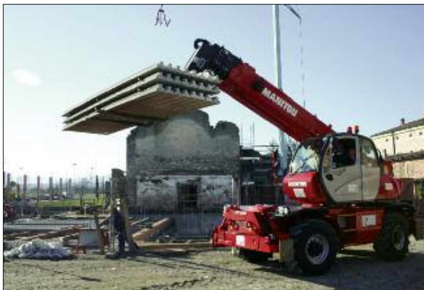
■ La trasmissione idrostatica con regolazione continua offre due velocità di traslazione in avanti e all'indietro, per una velocità massima di 36 km/h
