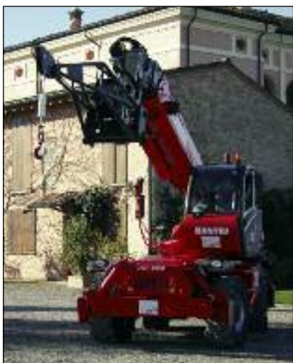
■ Il nuovo allestimento Privilège monta un motore Mercedes Benz a 4 cilindri da 4.250 cc della potenza di 110 kW a 2.200 giri, per una coppia massima di 580 Nm da 1.200 a 1.600 giri/min
