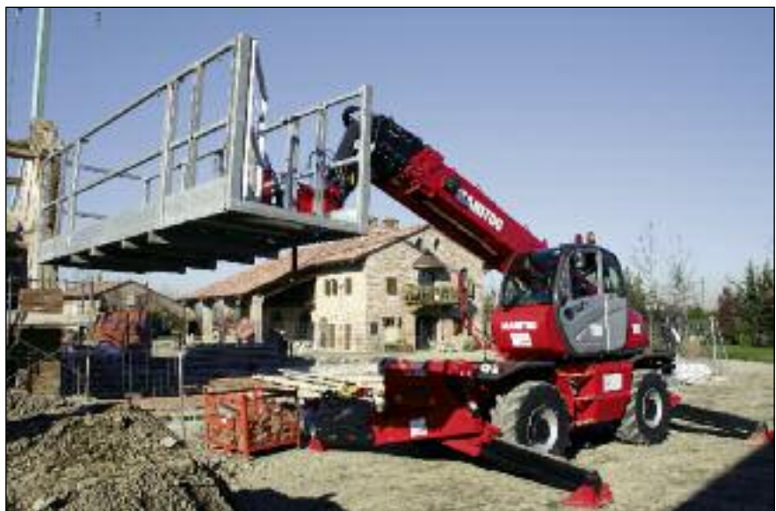
■ L'MRT 2150 nell'allestimento con piattaforma portapersona estensibile
