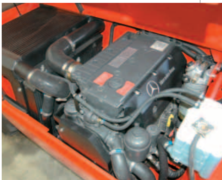
In alto, il Mercedes Om 904 La, un 4 cilindri a 4,2 litri. L'unità tedesca eroga al top di gamma (che equipaggia la serie Mht) 129 chilowatt a 2.200 giri, con una coppia di 660 Newtonmetro a 1.200 giri. A destra, l'Mht, telescopico a grande portata.
